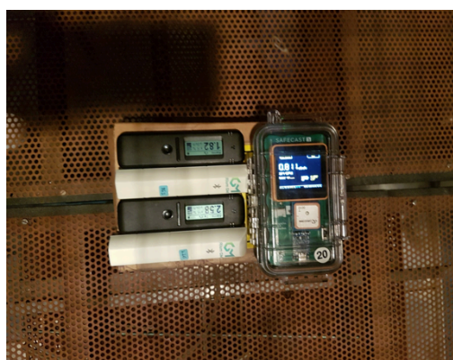
Figura 4. A la izquierda se observa una vista general del interior de la cámara climática del LER y a la derecha la disposición de los detectores durante la fase 4 de este estudio.
