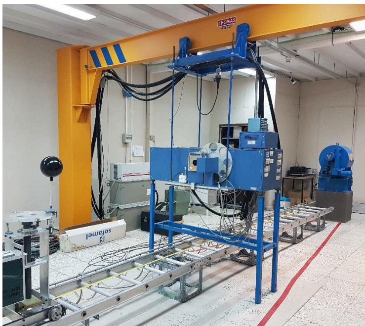
Figura 3. Instalaciones del LCD. El equipo de rayos X es móvil (en posición de trabajo en el centro de la imagen) y permite ser retirado cuando funciona el irradiador gamma (a la derecha en la imagen).
