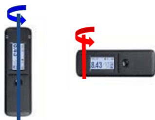
Figura 6. Ejemplo de rotación vertical (izquierda) y horizontal (derecha), en el caso del dispositivo Radiacode. El eje de rotación pasa por el baricentro del detector colocado en el interior de la carcasa.
